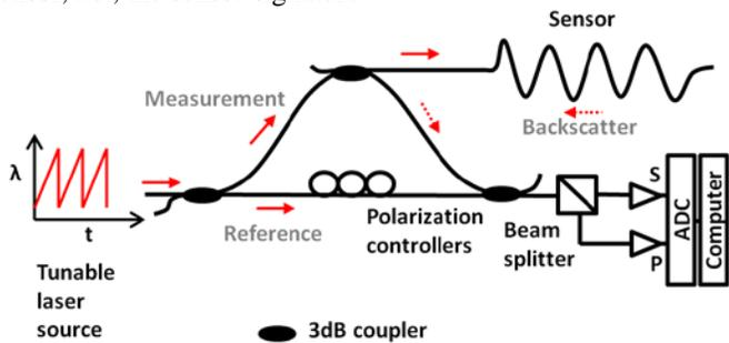
**FIGURE 1. BASIC OFDR OPTICAL NETWORK[11][12].**
