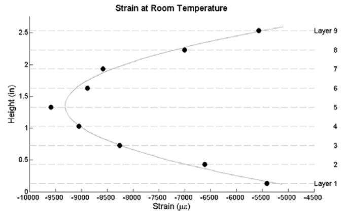
**FIGURE 11: THE RESIDUAL STRAIN PROFILE OF THE LARGE 3D PRINTED ABS BLOCK.**
